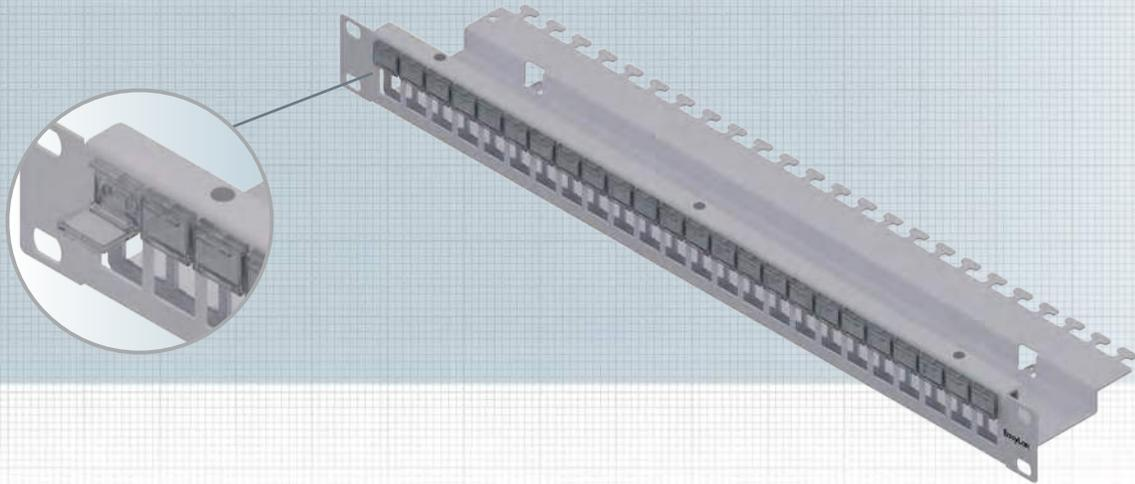
Das Verteilerfeld 19" 1HE ist beschaltbar mit bis zu 24 preLink® / fixLink® RJ45 Keystone-Modulen. Es ist in zwei Ebenen aufgebaut, somit sind die Module bündig in der Frontplatte. Das Verteilerfeld kann wahlweise in Edelstahl oder pulverbeschichtetem Eisenblech bestellt werden.
